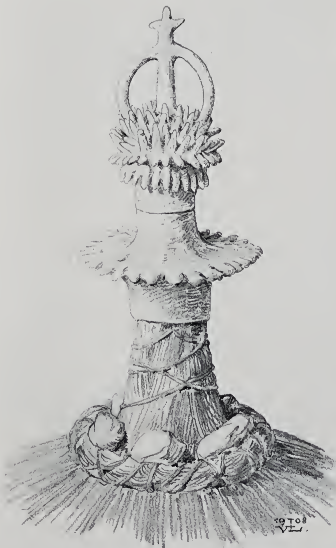
Abb. 32. Eindeckung der Spitze eines Kegeldaches.
